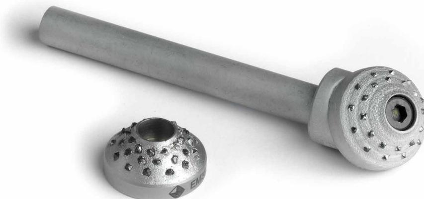
**Dresseur diamant multigrain serti à la main de diamants naturels tranchants. La répartition par douzaine (par section) permet de placer la couronne sur une nouvelle position dès que la dernière position utilisée est émoussée.**
